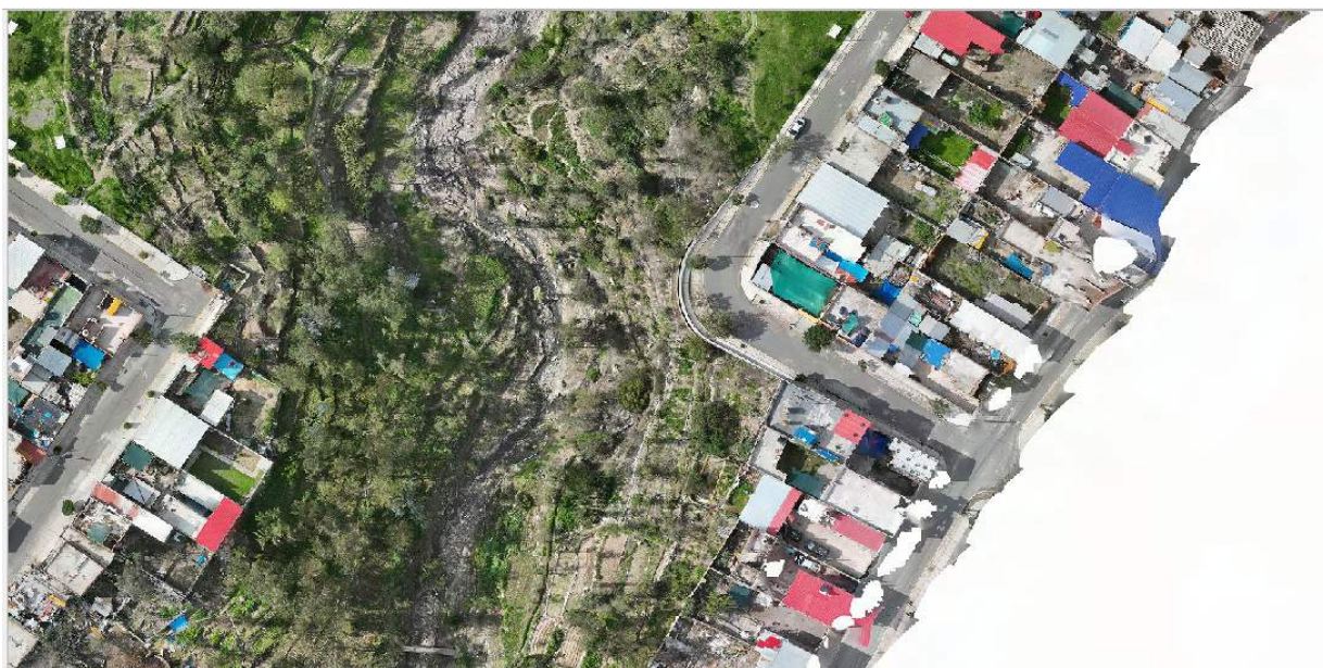
IMAGEN 03: EN ESTE TRAMO SE OBSERVA LA VISTA DE DRON, DONDE EL CAUCE DE LA QUEBRADA PASTORAIZ, SE ENCUENTRA COLMATADO, Y LAS VIVIENDAS SE ENCUENTRAN CERRCANAS AL SU CAUCE EN AMBAS MÁRGENES.
