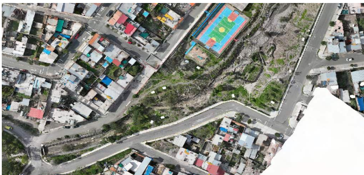
IMAGEN 04: EN ESTE TRAMO SE OBSERVA LA VISTA DE DRON; DONDE EL CAUCE DE LA QUEBRADA PASTORAIZ, SE ENCUENTRA COLMATADO, Y SIN PROTECCIÓN AMBAS MÁRGENES DE DICHA QUEBRADA; Y TAMBIEN SE OBSERVA ALAS VIVIENDAS CERCANAS AL CAUCE.
