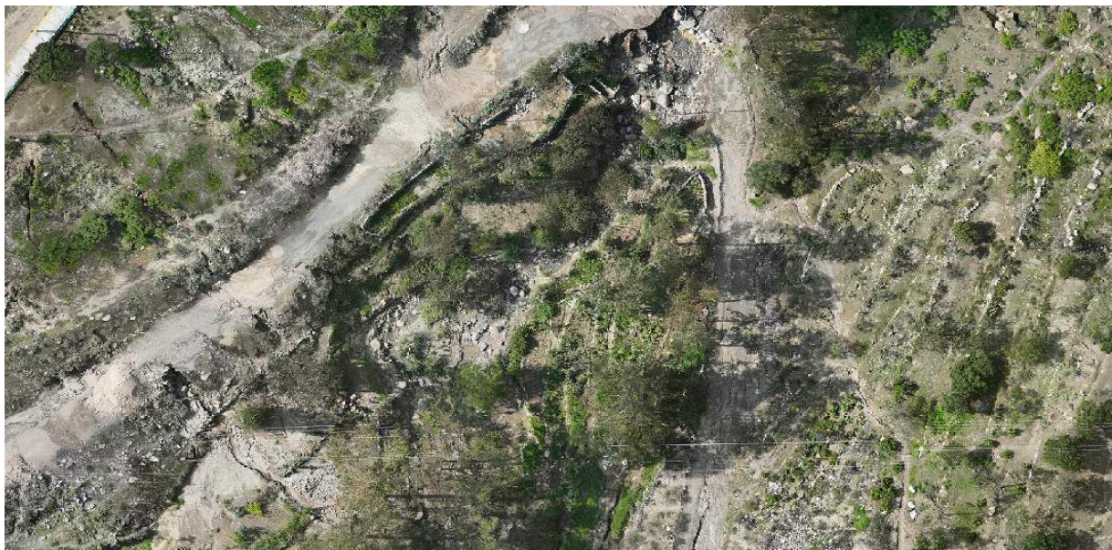
IMAGEN 01: SE OBSERVA LA VISTA DE DRON, EL CAUCE DE LA QUEBRADA PASTORAIZ, DONDE SU CAJA HIDRÁULICA SE ENCUENTRA COLMATADO DE SEDIMENTOS, Y SIN PROTECCIÓN EN AMBAS MARGENES DEL TRAMO.
